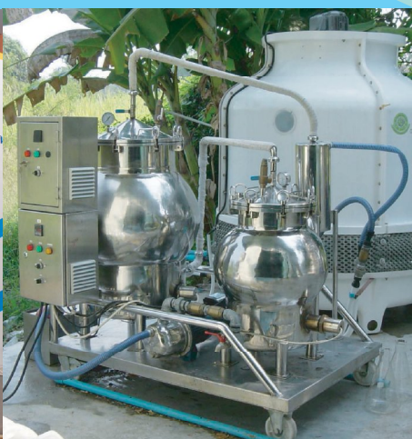
เครื่องสกัดน้ำมันหอมระเหยรุ่นที่ 3 (เครื่องกลั่นน้ำมันหอมระเหยด้วยไอน้ำแรงดันสูงขนาดเล็ก)
